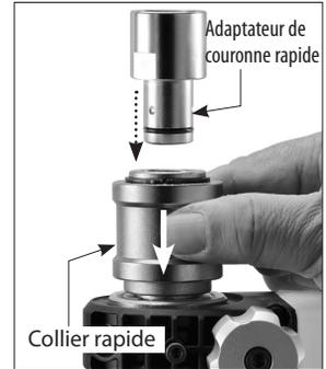
**ATTENTION : Maintenez propres les surfaces de l'adaptateur d'embout à fixation rapide et l'intérieur de l'assemblage du collier à fixation rapide. L'accumulation de poussière et de boue pourrait les coincer l'un contre l'autre.**
