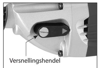
**OPGELET: Probeer de versnelling nooit te veranderen op een machine die in werking is! Pas de instelling alleen aan wanneer de machine in ruststand is.**
