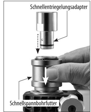
**ACHTUNG: Halten Sie die Oberflächen des Schnellwechsel-Bitadapters und das Innere der Schnellwechsellmanschette sauber. Angesammelter Staub und Schlamm könnten dazu führen, dass sie sich gegenseitig blockieren.**
