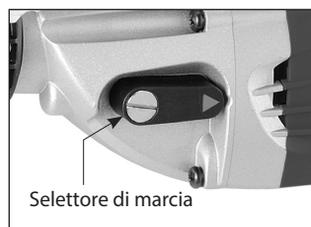
Far scattare la Linguetta del selettore di marcia fuori dal fermo, quindi far scorrere il selettore nuovamente all'indietro per la bassa velocità o in avanti per l'alta velocità per cambiare marcia. Potrebbe essere necessario girare leggermente il mandrino per innestare la marcia. Una volta innestata, far scattare la linguetta nel fermo.
