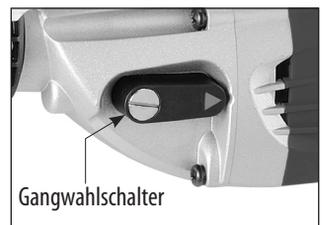
Drücken Sie die Gangwahlschalterabdeckung aus der Raststellung und schieben Sie dann den Gangwahlschalter nach hinten für den niedrigen oder nach vorn für den hohen Gang. Es kann notwendig sein, die Spindel leicht zu drehen, damit der Gang eingelegt werden kann. Drücken Sie nach dem Gangwechsel die Abdeckung wieder in ihre Raststellung.
