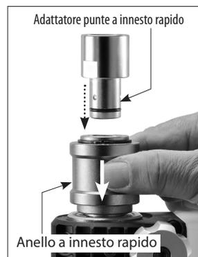
**ATTENZIONE: Mantenere pulite le superfici dell'adattatore per bit a rilascio rapido e l'interno del gruppo del collare a rilascio rapido. L'accumulo di polvere e liquami potrebbe causare l'inceppamento dei due componenti.**
