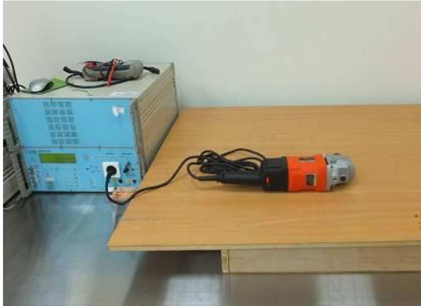
Figure 8 EFT test setup
